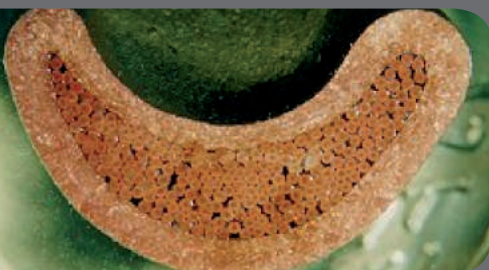
Presek kabl kod ubodnog presovanja sa prikazom jednakog rasporeda provodnika u spojnici.
