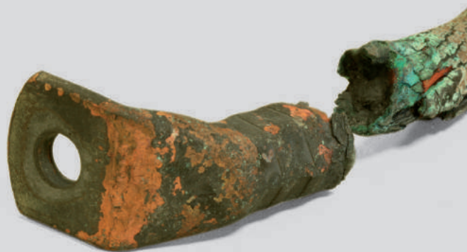
Neadekvatan alat ili neprofesionalno presovanje može uzrokovati visoke temperature ili paljenje.
